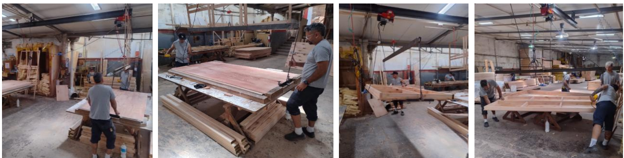
Figura 11. Imágenes de implementación de viga grúa y percha giratoria para LP.1 (Fuente: Ñande´)
