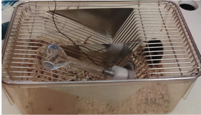
Figura 26. Lickometro capacitivo instalado en jaula.
