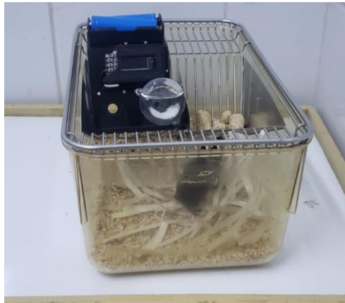
Figura 3. Lickometro fotoeléctrico montado en jaula.
