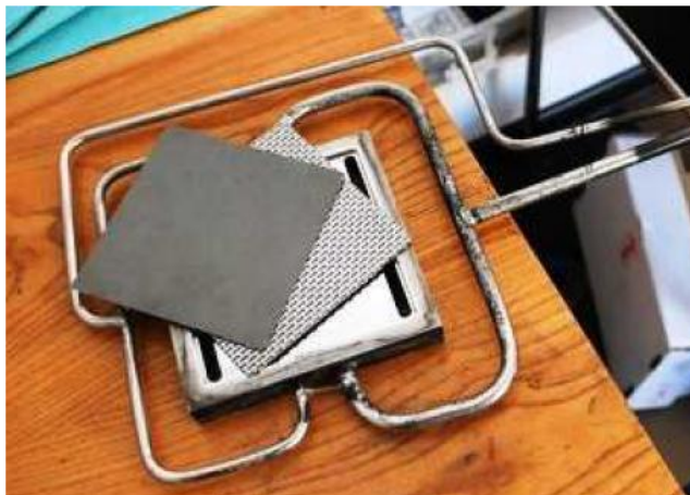
Figura 17: Celda única MCFC usada en pruebas [51]
