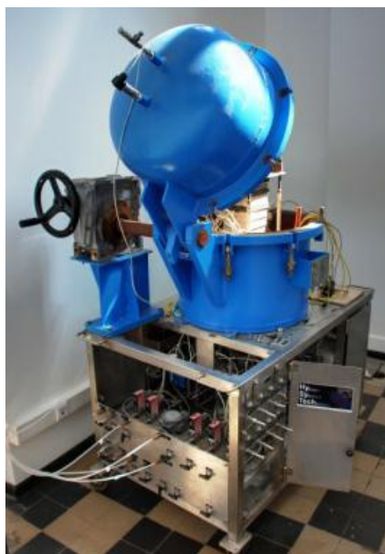
Figura 18: Instalación de prueba MCFC [51]
