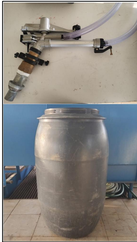
Figura 8. Aspersor con mangueras como extensión de las boquillas y recipiente de 220 L.
