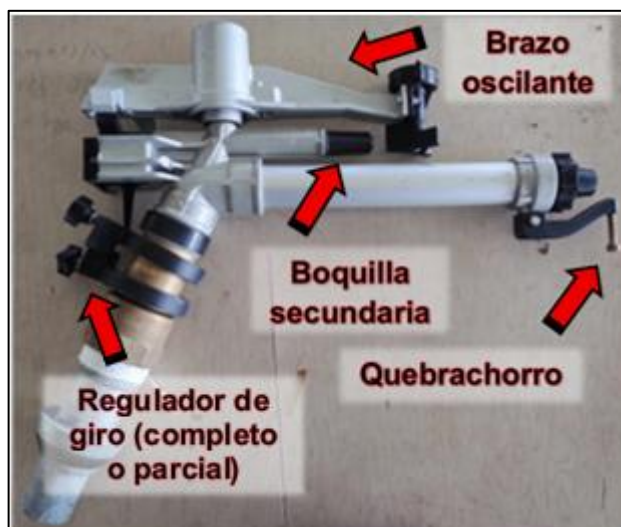
Figura 1. Componentes del aspersor marca SIME modelo Duplex.
