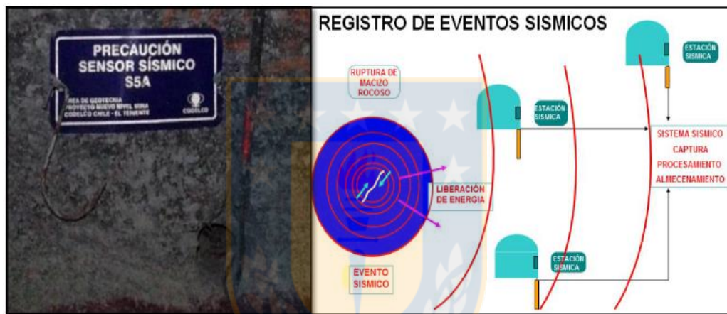
Figura 8.2: Sensor sísmico y esquema de registro de eventos DET. (Pozo, 2016)
