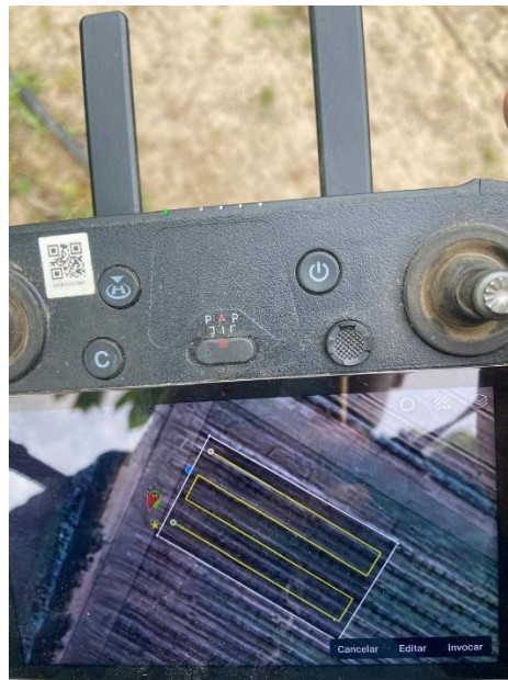
Figura 5. Mapeado del área de estudio en cerezos para que el dron realice la aplicación de forma automática.
