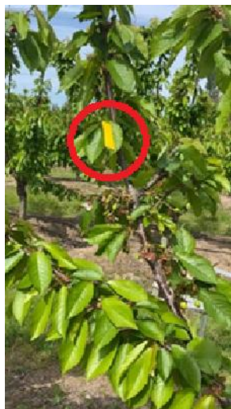
Figura 14. Ubicación de los papeles hidrosensibles en el nivel medio de los cerezos.
