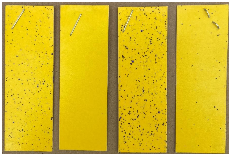
Figura 20. Resultados post-aplicación del vuelo 4 en cerezos, correspondiente al nivel medio.
