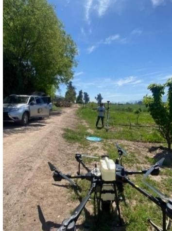
Figura 6. Imagen donde se muestra el dron fumigador, la antena RTK y la base de despegue del Mavic 3M.
