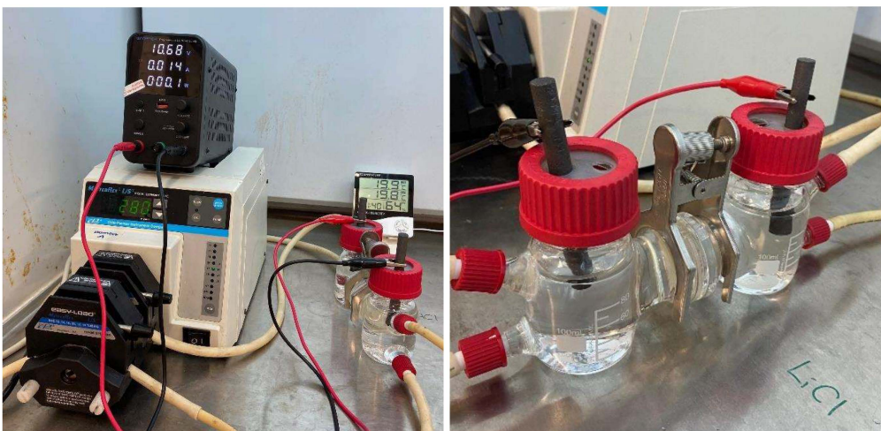
Figura 6. Correcto montaje del sistema de electrodiálisis.
