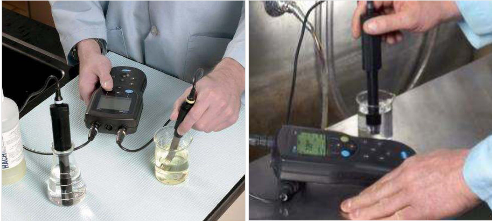
Figura 5. Uso correcto del electrodo ISE.
