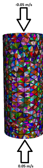
Figura 3.4: Representación de vectores de fuerza axial para ensayo UCS
