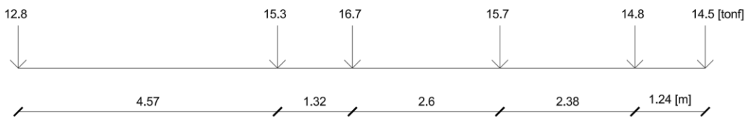
Figura A.4.2.8 Supercamión representativo de estación “Curacaví” (Cu-12-6E-90) en dirección 1-2
