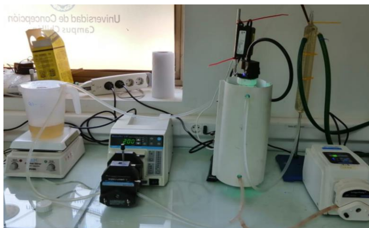
Figura 14. Sistema de tratamiento del efluente de celulosa a escala de laboratorio, utilizando un sistema de control de temperatura del tipo serpentín.
