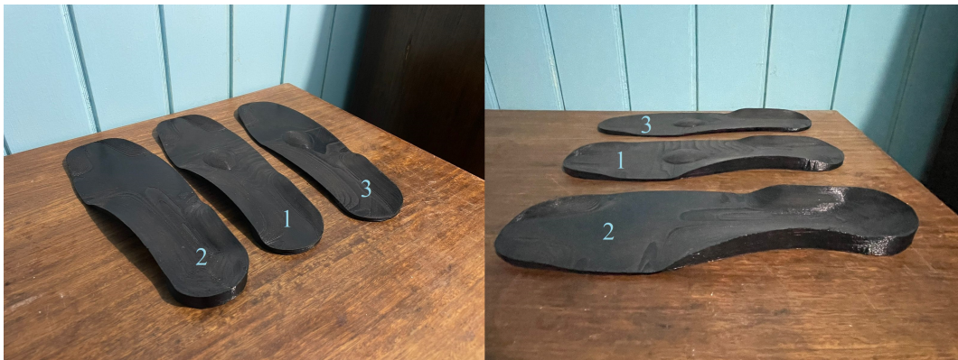
Figura 4.4: Modelos de plantillas ortopédicas impresas en TPU con infill de (1) 20 %, (2) 40 % y (3) 60 %.
