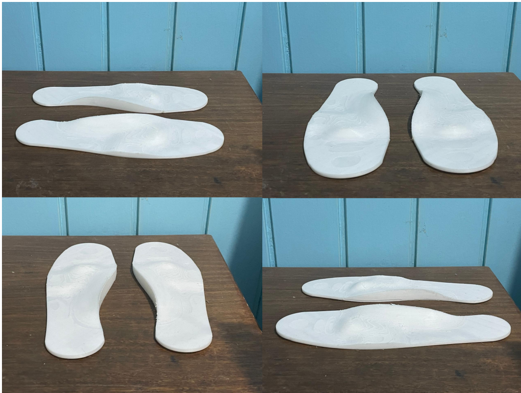
Figura 4.5: Plantillas ortopédicas impresas en TPE según receta.
