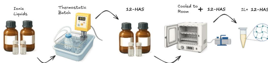
Figura 7. Metodología para la gelificación de los líquidos iónicos.
