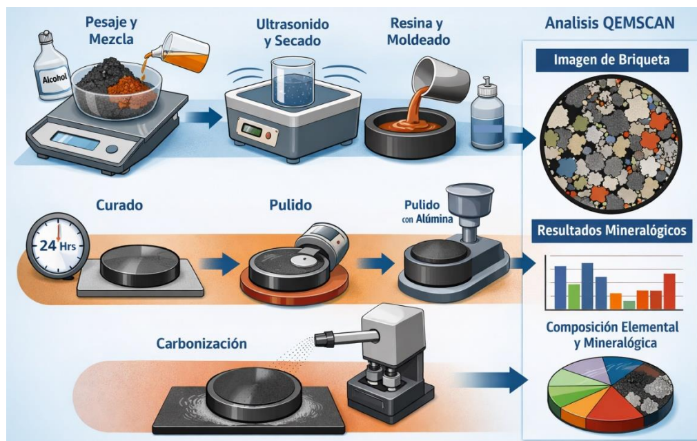
Figura 5.1 Proceso de preparación de muestras y fabricación de briquetas para análisis QEMSCAN. (Elaboración propia)
