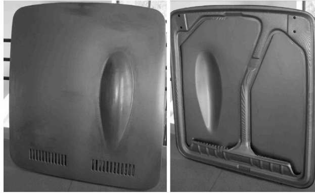
Figura 1.3 Capot Honda s800 fabricado mediante conformado incremental.
