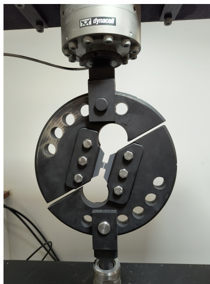
Figura 3.12 Probeta mariposa montada en dispositivo Arcan.
