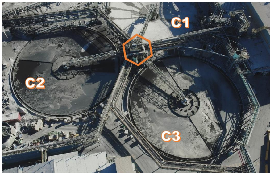
Figura 2.1: Vista superior de Distribución de Concentrado desde Hexagonal hacia Espesadores C1, C2 y C3. (Imagen capturada por la empresa).
