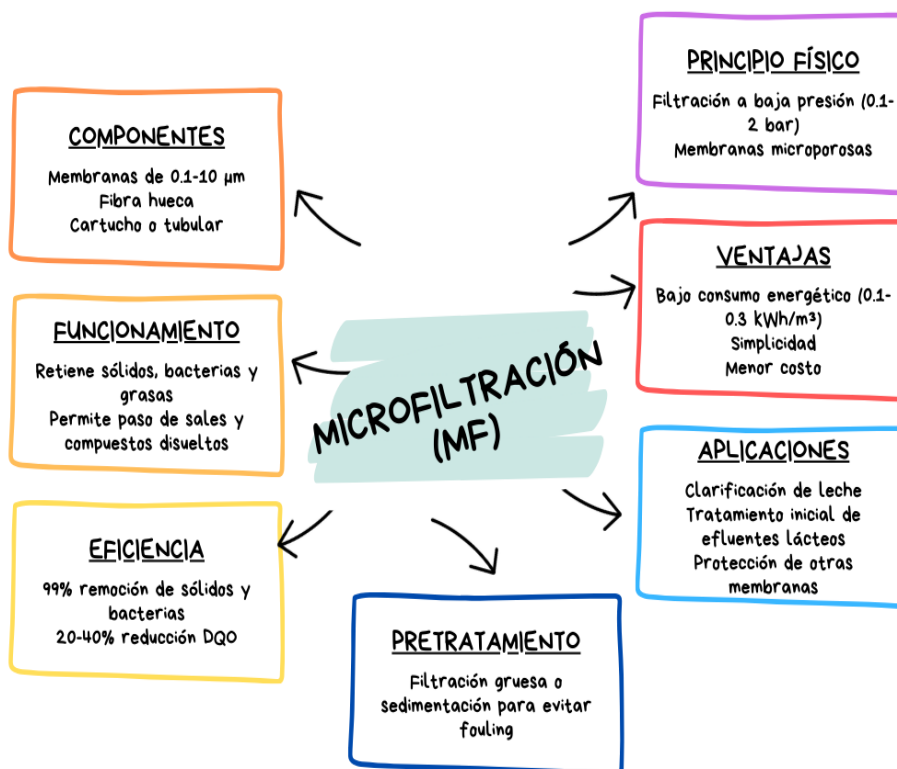
Figura 4. Mapa conceptual del proceso de Microfiltración (MF) aplicado al tratamiento de aguas residuales de la industria láctea. (Elaboración propia a partir de Baker 2012; Ritambhara et al. 2019; Figueroa et al. 2021 y CONAMA 2001).
