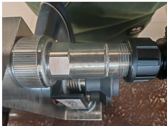
Figura 2.24 Acelerómetro PCB 603C01 utilizado para la medición de vibraciones.
