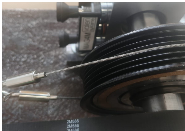
Figura 2.11 Cable de acero ajustable utilizado en el sistema de tensado.
