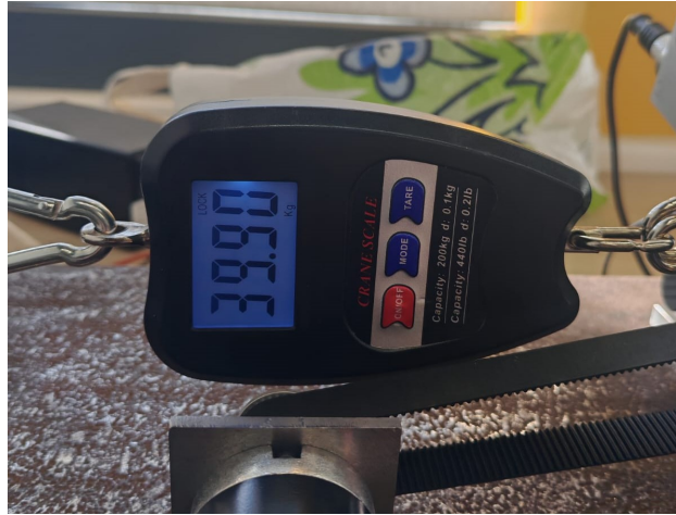
Figura 2.10 Dinamómetro digital utilizado en el banco de ensayos.
