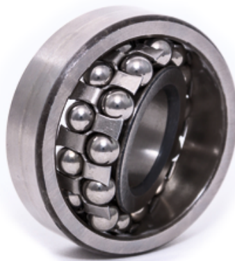
Figura 2.1 Rodamiento SKF 1302 ETN9 con pista exterior parcialmente girada [12].
