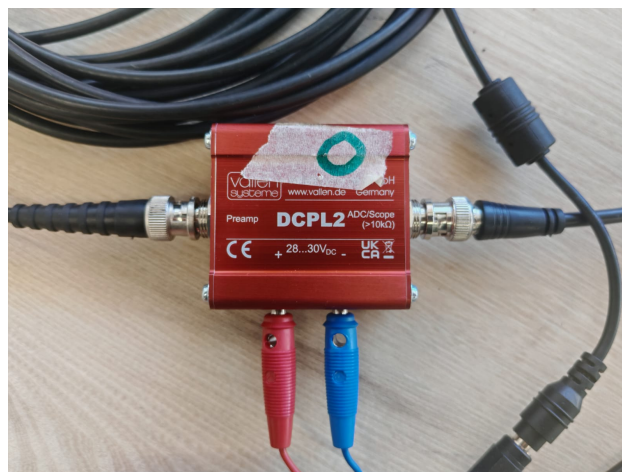
Figura 2.30 Desacoplador Vallen DCPL2 utilizado en la cadena de medición de emisión acústica.
