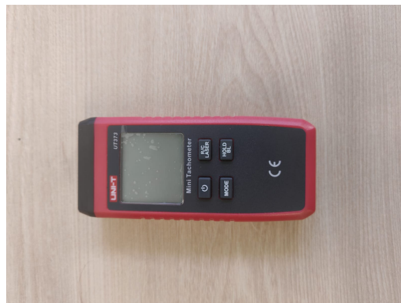
Figura 2.33 Tacómetro digital sin contacto UNI-T UT373 utilizado para verificar la velocidad de giro del eje principal.
