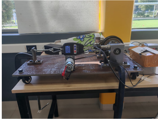
Figura 4.1 Disposición de las prensas utilizadas para reducir la vibración del banco durante los ensayos.
