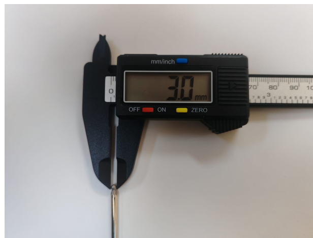
Figura 2.36 Punta diamantada de 3 mm de diámetro utilizada para generar la falla localizada.
