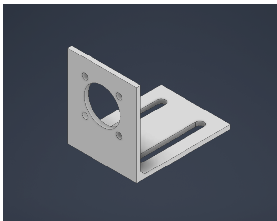
Figura 2.5 Modelo 3D del conjunto placa soporte del motor.
