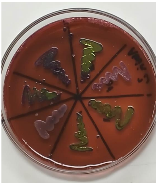
Figura 6. Prueba positiva de aislamiento de E. coli de una muestra de agua (mL) en una solución con Agar Levine.
