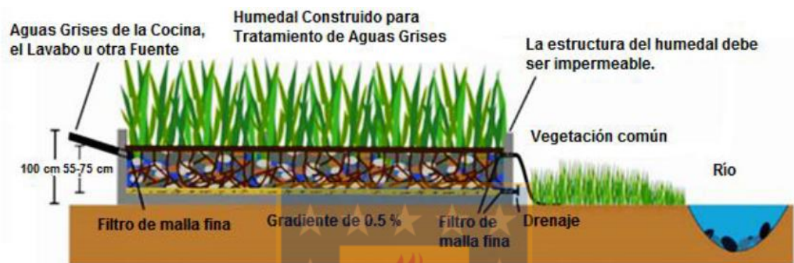
Figura 6 Un sistema subterráneo típico de humedales construidos
