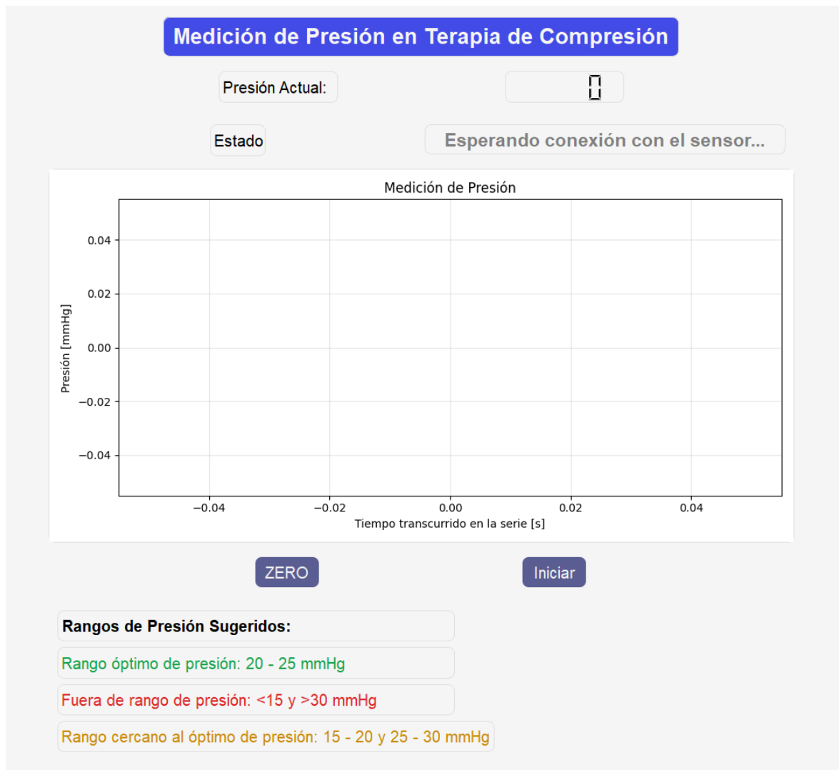
Fig. 4.15: Primera página de la interfaz que muestra una previsualización de la presión medida, que indica el estado del valor dependiendo del rango en el que el valor se encuentra, si está fuera de rango, o si el dispositivo no está conectado aún, como es el caso de lo visto en la figura.
