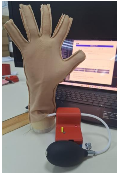
Fig. 4.20: Medición del punto M2 usando el dispositivo propuesto, el cual se encuentra dentro de una caja diseñada a medida.
