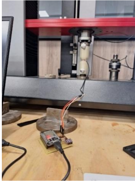
Fig. 4.6: Medición de la diferencia de capacitancia con la máquina de ensayos Zwick-Roell ProLine Z010, utilizando el sistema configurado con un solo sensor.
