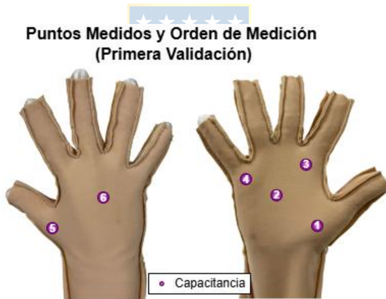
Fig. 4.8: Puntos medidos para visualizar la variación de capacitancia en diferentes puntos de la mano, con cuatro puntos en la palma y dos en el dorso, seleccionando aquellos que suelen ser comunes en quemaduras.
