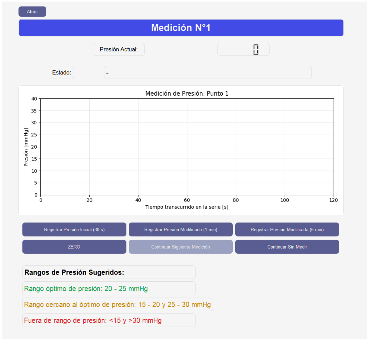
Fig. 4.17: Visualización de la primera medición, donde se registran valores durante 30 segundos inicialmente, luego para la fase de intervención para aumentar la presión, se puede seleccionar botón de 1 o 5 minutos para visualizar los cambios de presión obtenidos a través del tiempo.
