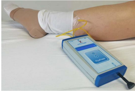
Fig. 1.7: Dispositivo de medición de presión subvendaje PicoPress. Imagen extraída de [63].
