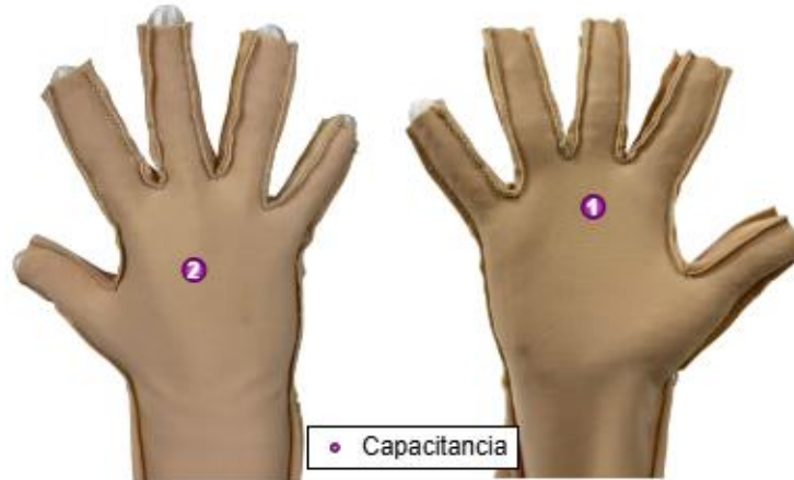
Fig. 4.9: Puntos medidos para ser reemplazados en la ecuación obtenida de la calibración del sistema con un solo sensor.
