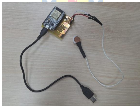
Fig. 4.5: Implementación del sistema usando un sensor, donde se conecta solo a un canal de medición del FDC1004, además del cable de tierra y el apantallamiento.
