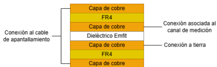
Fig. 4.2: Estructura del ensamblaje de los sensores capacitivos a fabricar, compuesto de dos láminas de cobre flexible y una capa interna de PET como dieléctrico.
