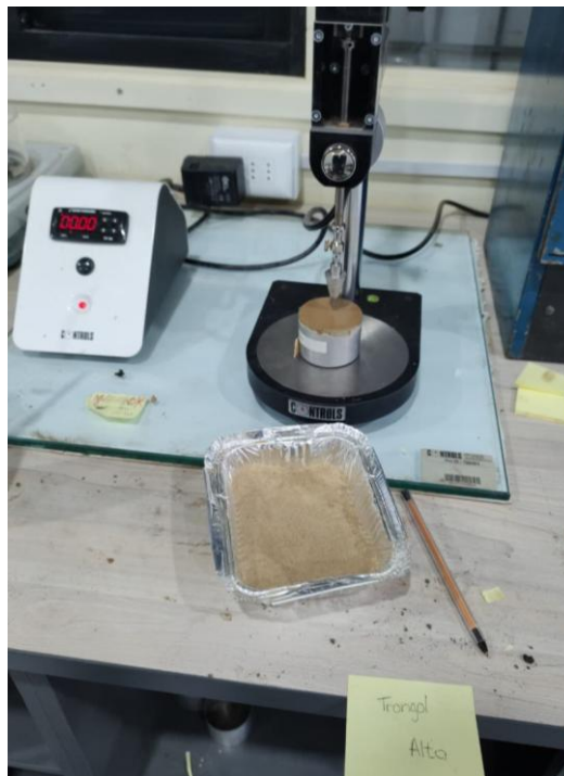
Figura 3-6. Máquina de penetración dinámica en laboratorio de suelos, Facultad de Ingeniería.
