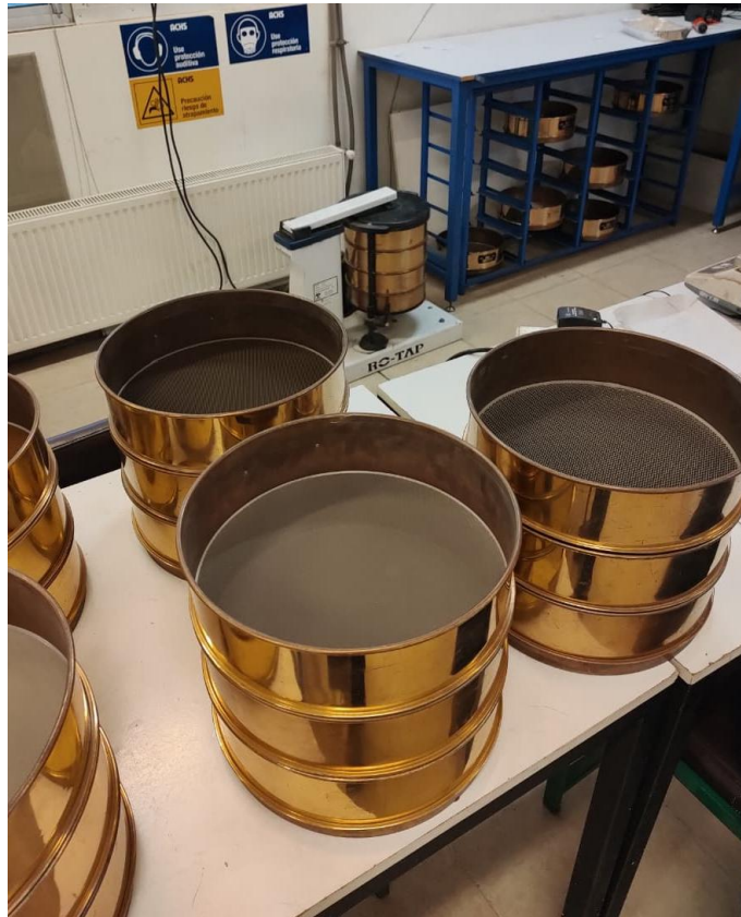
Figura A 3.2.2. Tamices utilizados y tamizadora mecánica en laboratorio de hidráulica.
