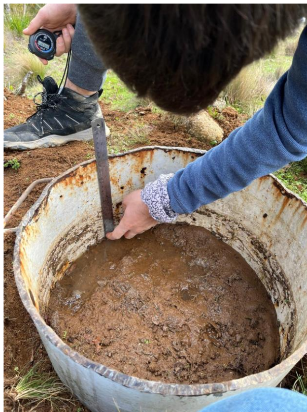
Figura A 3.2.4. Toma de muestras anillo simple, Bajo Cifuentes
