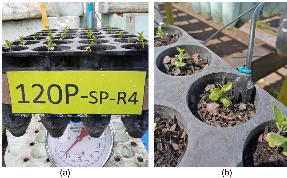
Figura 3. (a) Pesaje de bandejas para determinar el contenido gravimétrico de agua; (b) Sensores de humedad para determinación del contenido volumétrico de agua desde la bandeja.
