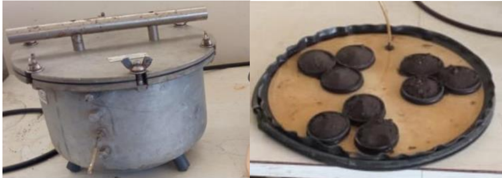
Figura 6. Olla de presión y muestras de suelo en plato de succión.
