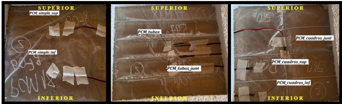
Figura 20: Termistores instalados rotulados. Fuente: Elaboración propia.
