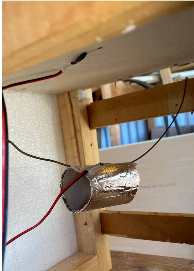
Figura 16: Termistores correspondientes a la pared interior y el aire ambiente. Fuente: Elaboración propia.
