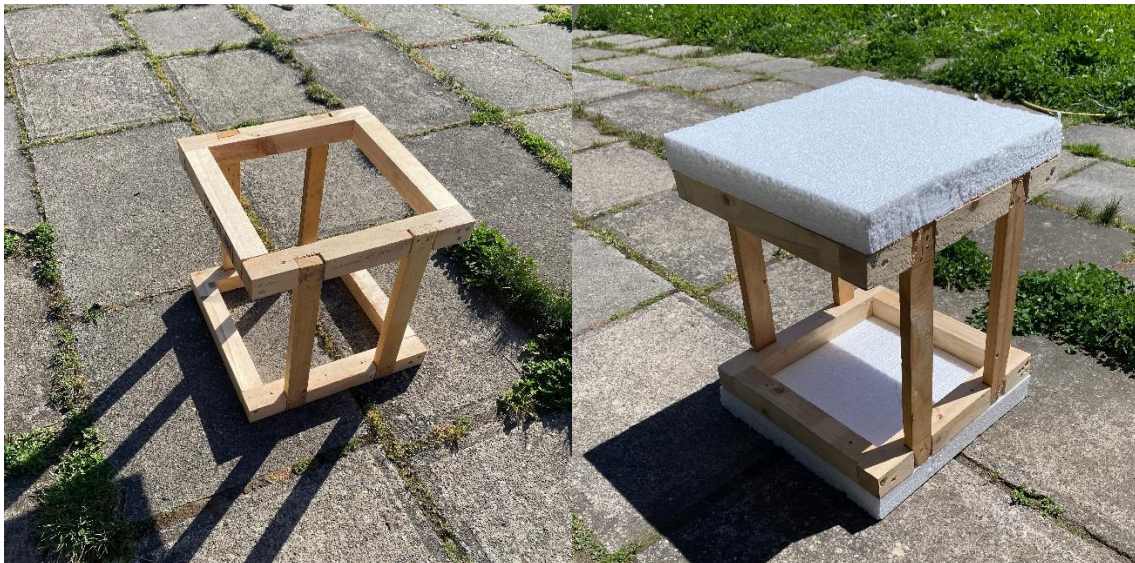
Figura 12: Estructura de cubos y capa de poliestireno. Fuente: Elaboración propia.
