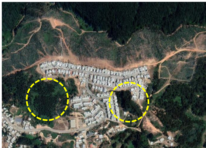
Figura 28: Imagen satelital del sector analizado, en el mes de Febrero de 2020. En círculo amarillo, sectores sin cortafuego. Fuente: Google Earth.
