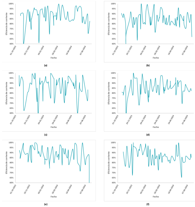
Figura 14. Variación en el tiempo de la eficiencia de corriente por sección en el circuito E. (a) E1; (b) E2; (c) E3; (d) E4; (e) E5; (f) E6.
