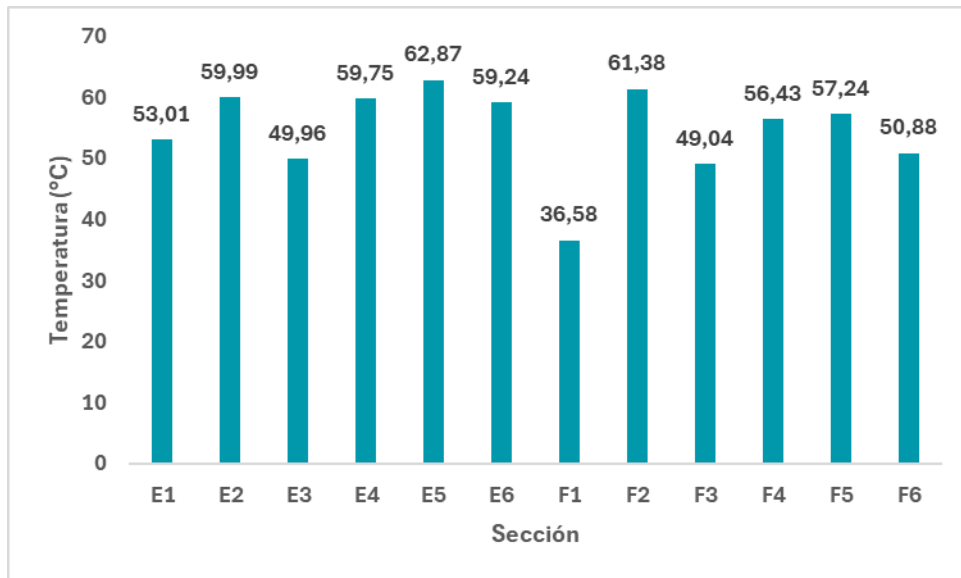
Figura 18. Temperatura promedio de las busbars por sección.
