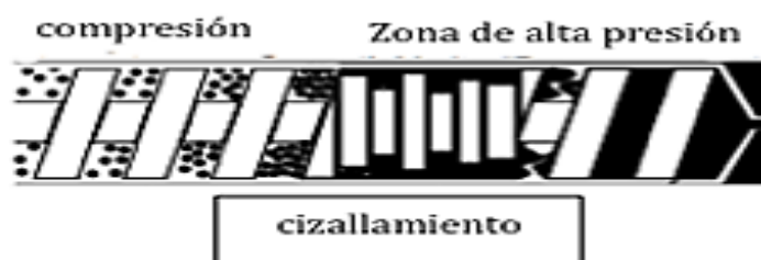
Figura 7. Comportamiento del producto dentro de la camisa del extrusor. (Guy, 2001)
