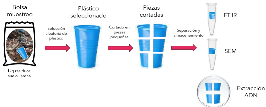
Figura 3: Esquema del procesamiento de muestras obtenidas, a partir de la bolsa de muestreo que contiene aproximadamente 1 kg de residuos, suelo y arena, la selección del residuo plástico, corte en trozos más pequeños y finalmente separación de acuerdo al proceso posterior, ya sea FTIR, SEM o Extracción de ADN.
