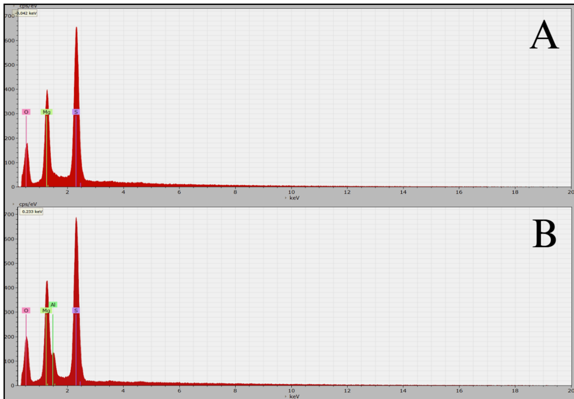
Figura 4.16: Contaminación por aluminio en minerales. Espectros EDS obtenidos de M-17 correspondiente al mineral Epsomita (Sulfato de Magnesio), en A se observa el espectro con los elementos correspondientes mientras que en B se leen rayos X característicos del aluminio, elemento que no forma parte de la estructura del mineral natural.
