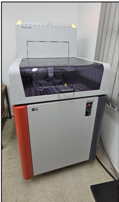
Figura 3.1: Difractómetro de rayos X. Modelo D4 Endeavor de Bruker.
