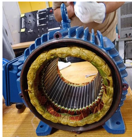
Figura 1.2: Fotografía de estator de un motor de inducción con sus bobinados tomada en la Universidad de Concepción.
