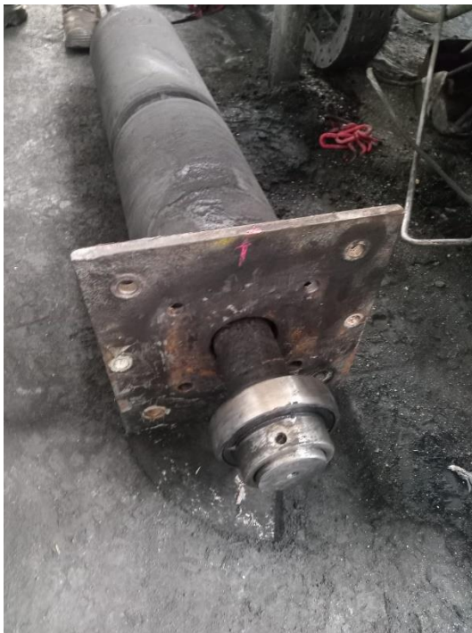
Figura 21. Estado del polín motriz una vez retirado. (Fuente: ENAP)
