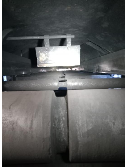
Figura 20. Guía en "V" de los polines y rodillos desalineados. (Fuente: ENAP).
