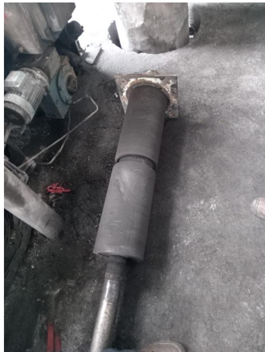
Figura 21. Estado del polín motriz una vez retirado. (Fuente: ENAP)
