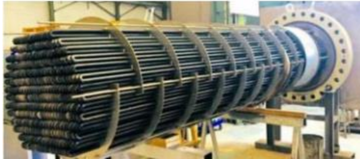
Figura 19: Calentador eléctrico de sales [7].
