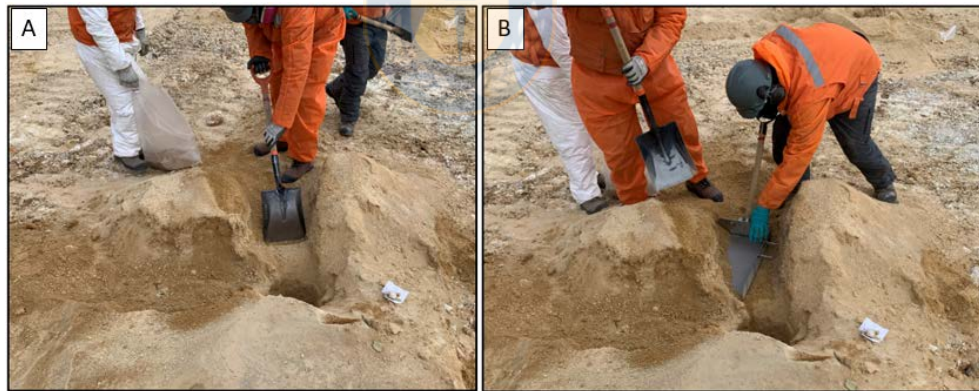
Figura 4.07. Extracción de cutting con método radial y pala llana. A: Se realiza el corte del cono con pala plana. B: Se realiza la extracción de muestra con pala llana.
