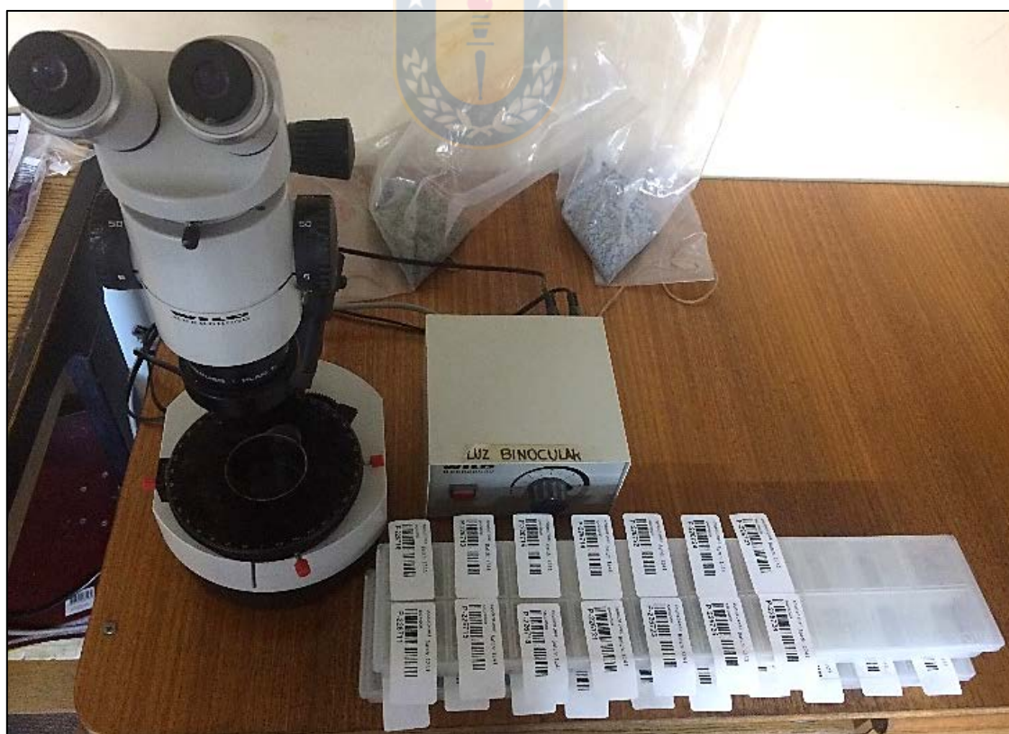
Figura 3.15. Lupa electrónica con aumento 50X Wild Heerbrugg. Sistema binocular junto a bandejas de cutting codificadas para mapeo geológico.
