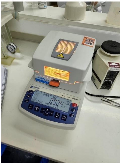
Figura 8. Termobalanza utilizada para la medición de humedad de las muestras de estiércol equino.
